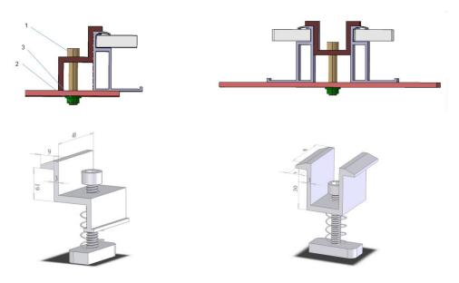
Fig. 2 clamps fixed module
