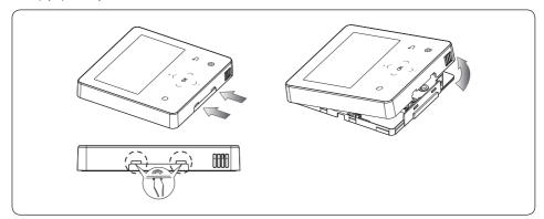
2 Napájecí a komunikační kabel veďte ve skříni podél okrajů zadního krytu.
