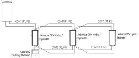
2 Použití jednoho kabelového dálkového ovladače k ovládání jednotek Hydro DVM / jednotek Hydro HT připojených k jiné venkovní jednotce Venkovní jednotka
