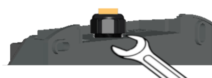
Obr. 6-15: Utažení kabelové průchodky ze zadní strany
